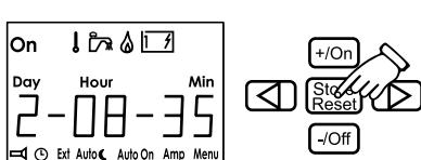
Wenn die Stromversorgung zur Bedieneinheit unterbrochen wird und kein Batterie-Backup angeschlossen ist, muss die Uhr neu eingestellt werden.
