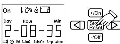
Si la tension vers le tableau est coupée et que le backup de la batterie n'est pas connecté, il faut à nouveau régler l'horloge.
