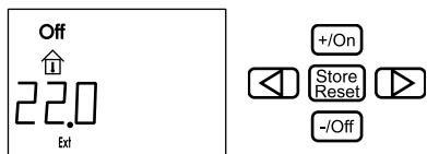
Når ekstern start aktiveres, starter varmesystemet med de sist brukte innstillingene og "ON" (hovedbryteren) tennes. Hvis det ikke er koplet til 12 V til varmesystemet, vil displayet være slukket til 12 V tilkoples. Funksjonen ekstern start er fortsatt aktivert.
