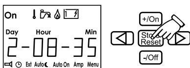
Jeśli zasilanie panelu zostanie odcięte, a zasilanie z akumulatora jest wyłączone, zegar musi być ustawiony ponownie.
