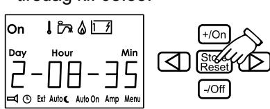
Hvis strømmen til panelet brytes/afbrydes og reservebatteri ikke er tilkoplet/tilsluttet, må/skal klokken stilles inn på nytt.
