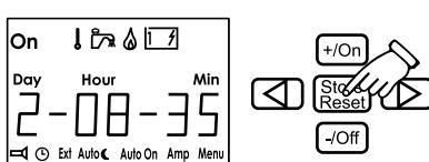
Indien de stroomtoevoer naar het bedieningspaneel wordt verbroken en er geen batterijbackup is aangesloten moet de tijd opnieuw worden ingesteld.
