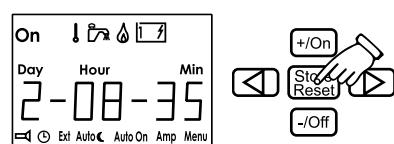
Če se prekine oskrbovanje toka do upravljalne enote in nimate priklopljenega dodatnega akumulatorja, morate uro ponovno nastaviti.
