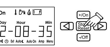
In caso di interruzione di corrente al pannello di controllo, se la batteria di riserva non è collegata, l'orologio deve essere reimpostato.
