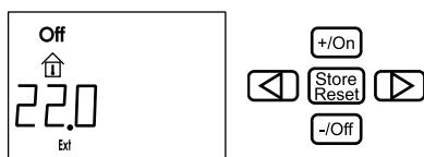
Kiedy uruchamianie zewnętrzne jest aktywowane, ogrzewanie zaczyna pracować zgodnie z ostatnimi ustawieniami i „ON” (główny wyłącznik) zapala się. Jeśli ogrzewanie nie ma połączenia ze źródłem prądu o napięciu 12 V, wyświetlacz jest nieaktywny aż do pojawienia
