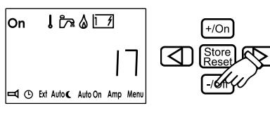
Toiminto on oletusarvoisesti poistettu käytöstä. Tämän toiminnon käyttäminen edellyttää kuormituksen varokytkimen (3010246) asentamista 230 V sähkökeskukseen. Aktivoi toiminto käynnistämällä ensin alemman rivin toiminnot (katso kohta 12).
