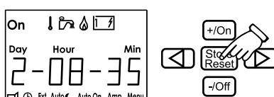
Om spänningen till panelen bryts och batteribackup inte är ansluten måste klockan ställas in på nytt.
