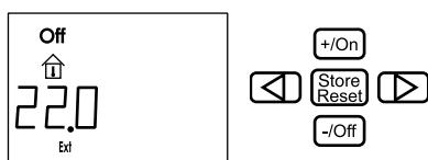
Funkcija eksterni vklop (upravljanje na daljavo) je aktivirana. Če je funkcija eksterni vklop aktivirana, se bo ogrevalna naprava vklopila z zadnjimi nastavitevami, na prikazovalniku sveti "ON" (glavno stikalo). Če za oskrbovalno napravo ni na razpolago oskrbe z 12 V,
