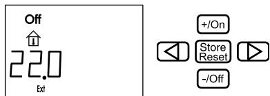
All'attivazione dell'avvio esterno, lo scaldabagno si avvia con le ultime impostazioni e sul display appare "ON" (interruttore principale). Il display non si accende se non è collegato all'alimentazione elettrica a 12 V. La funzione di avvio esterno rimane attivata.
