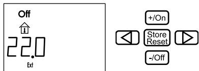
Lorsque le démarrage à distance est activé, la chaudière se met en marche selon les derniers réglages effectués et "ON" (disjoncteur principal) s'allume. Si la 12 V n'est pas reliée à la chaudière, le display restera éteint jusqu'à ce que la 12 V soit connectée. La fonction démarrage à distance reste activée.
