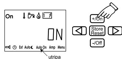
Ko ste prispeli k vozilu, ladji ali zgradbi in je vklopljena funkcija AutoOn, potem izklopite AutoOn, da bi tako preprečili ustavitev ogrevalne naprave po 24 urah.
