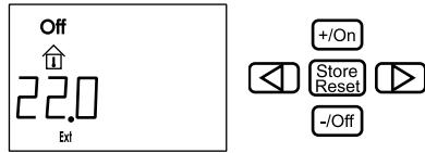
Kun ulkoinen käynnistys otetaan käyttöön, lämmitin käyttää käynnistyessään viimeksi valittuja asetuksia ja tekstikentässä näkyy teksti "ON" (pääkytkin). Jos lämmitin ei saa 12 V:n jännitetä, näyttö on sammuksissa, kunnes 12 V:n virransyöttö kytetään. Ulkoinen käynnistys on yhä käytössä.
