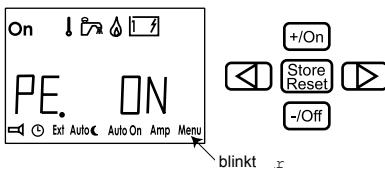
**3** Drücken Sie auf -/Off, um den konstanten Pumpenbetrieb abzuschalten. Drücken Sie anschließend auf Store, um die Funktion für konstanten Pumpenbetrieb zu verlassen.
