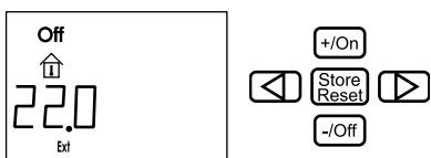
När extern start aktiveras kommer värmepannan att starta med de senaste inställningarna och "ON" (huvudbrytaren) tänds. Om inte 12V är ansluten till värmepannan, kommer displayen vara släckt tills 12V ansluts. Funktionen extern start är fortfarande aktiverad.
